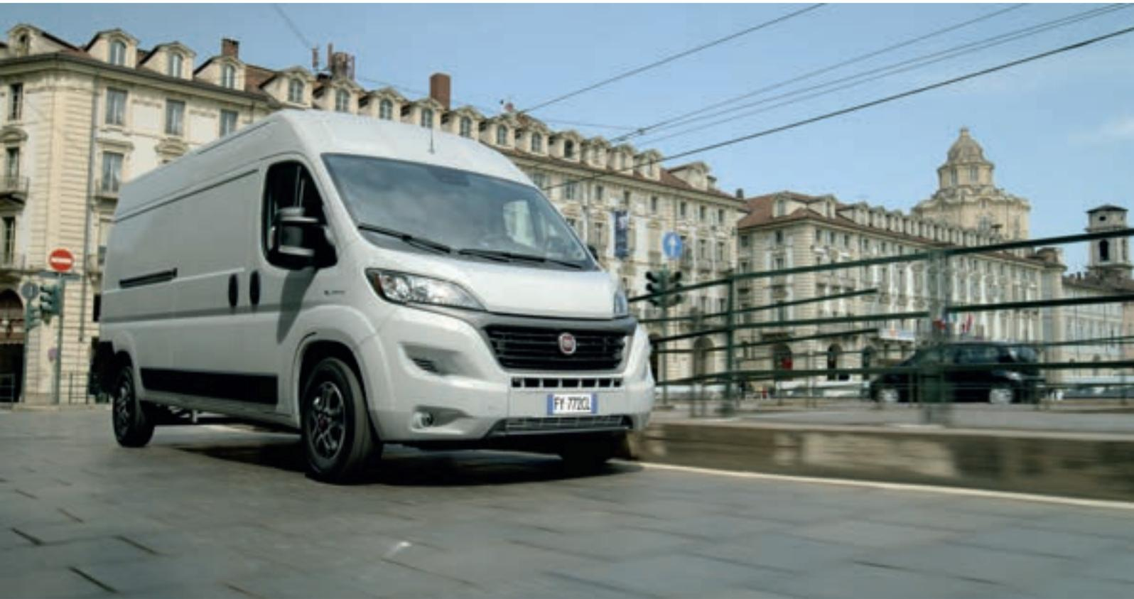
devrait permettre au fourgon de couvrir une distance théorique de 280 km, voire jusqu'à 370 km en ville. Le E-Ducato peut également bénéficier d'une recharge rapide qui, à la borne de recharge appropriée, lui permet de recharger jusqu'à 100 km en 30 minutes.
