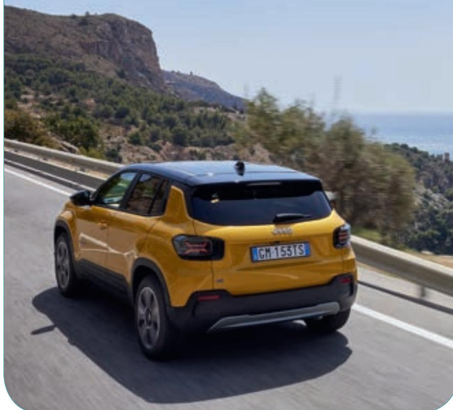
chocs et les flancs font l'objet d'une attention particulière grâce à une conception intelligente des plastiques et des protections. En cas de collision ou d'accident de stationnement, seuls les bords protecteurs en plastique sont touchés en premier, afin de limiter les dégâts plus importants et plus coûteux sur la carrosserie.
