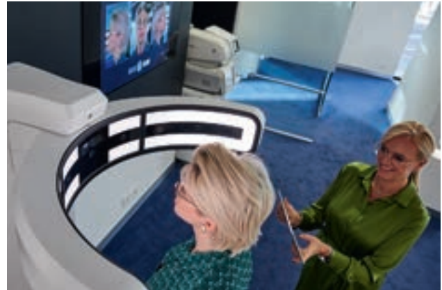
Centratie van de glazen met het Zeiss Visufit 1000 platform
